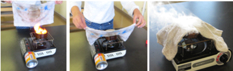
サラダ油を入れた空き缶を熱し、火がついたら水で濡らしたぞうきんをゆっくり被せる。木の板を被せる実験も同様に行う。
